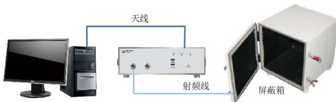
图 4.空口(OTA)测试硬件连接示意图
